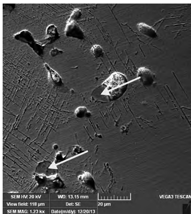
Obr. 6 Nekovové vměstky ve struktuře kovu fragmentu A (foto z elektronového skenovacího mikroskopu Tescan Vega 3 Š. Msallamová)
